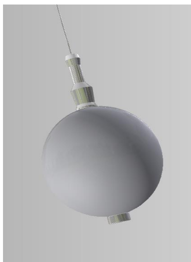
Рис. 4. Шар маятника Фуко Марийского университета в сборе (схема из проектной документации) / Fig. 4. Ball of the Foucault pendulum of the Mari University as an assembly (scheme from the project documentation)
