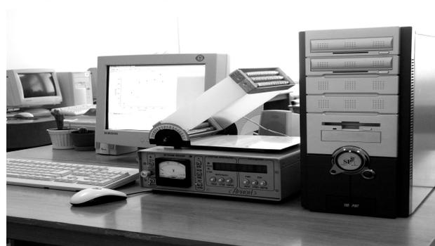
Рис. 3. Пример лабораторной установки «Арион» по изучению космического излучения (электронный блок, космический «телескоп», компьютер)
