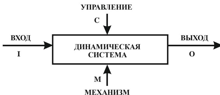
Рис. 1. Структурно-функциональная SADT-модель динамической системы с выделенными параметрами /
